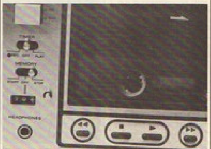
Photo G. - Compteur, présélection pour démarrage automatique et touches électromagnétiques.
